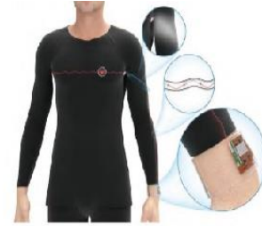
图8 可穿戴式人体生理参数系统采集系统图
