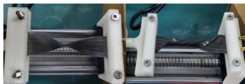
图 13 拉伸电阻传感器 DNA 双螺旋扭转状态（左）及单螺旋扭转（右）
