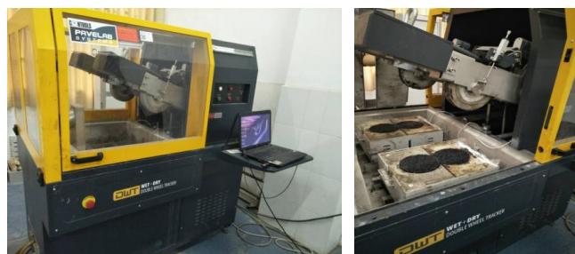
图 1 汉堡车辙试验
