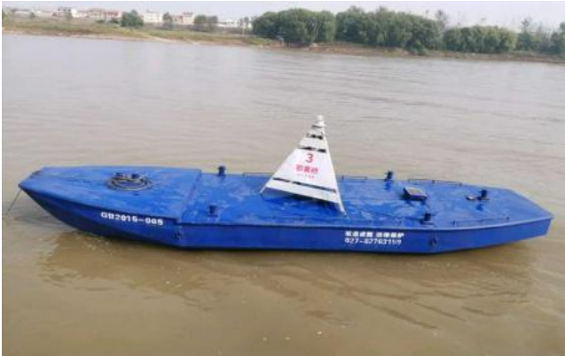
图 4 涂装水性石墨烯重防腐涂料浮标在长江干线黄冈段试用 经过为期 8 个月的试用，目前浮标使用观感良好，
