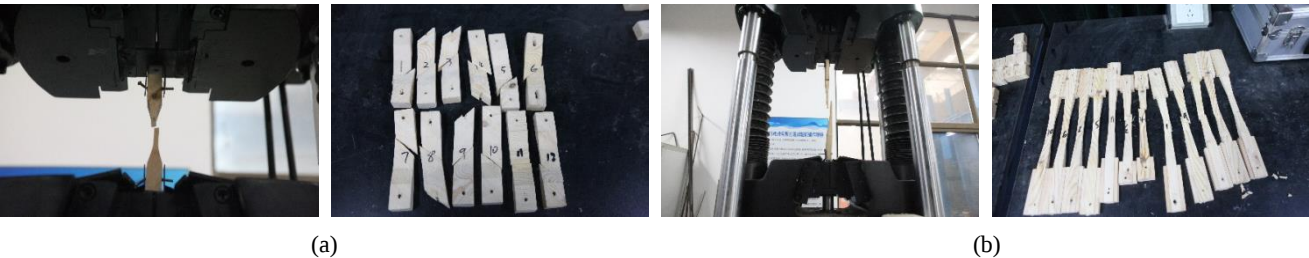
图 1 樟子松抗拉强度试验: (a)垂直于木纹方向拉伸试验的破坏现象; (b)平行于木纹方向拉伸试验的破坏现象
