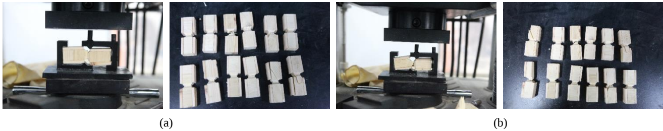
图 3 樟子松抗拉强度试验：(a)垂直于木纹方向剪切试验的破坏现象；(b)平行于木纹方向剪切试验的破坏现象
