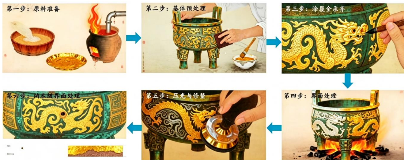
图1 鎏金工艺的具体步骤图
